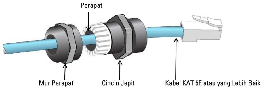
1. Masukkan kabel ke dalam mur perapat (konektor RJ45 belum terpasang).
